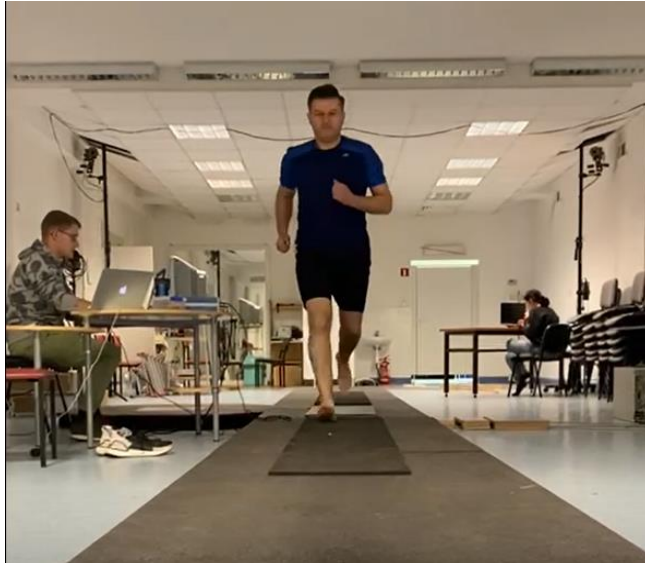
Ryc. 14. Pomiar rozkładu obciążenia stóp podczas biegu (źródło własne)
